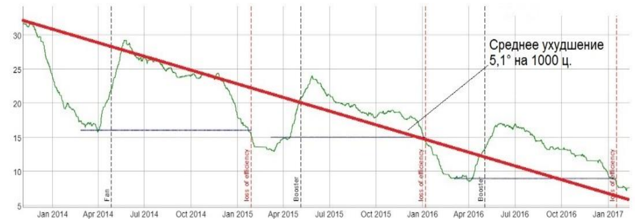
Развитие EGTHDM при выполнении промывок на примере двигателя 575622 типа CFM56-5B3/P
